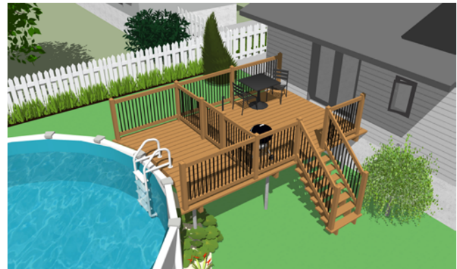
Exemple de terrasse rattachant la piscine à la résidence. La partie ouvrant sur la piscine est adéquatement protégée par une enceinte.
