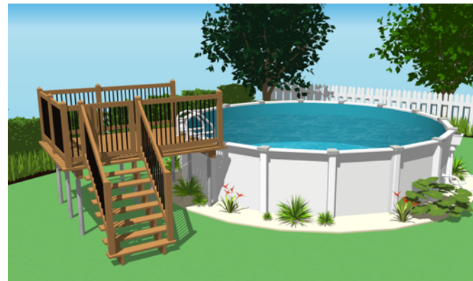
Exemple de plateforme dont l'accès est protégé par une enceinte.
