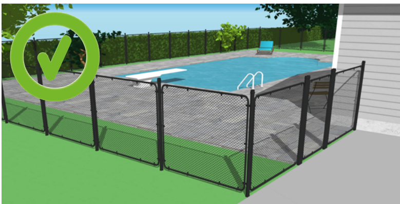
Exemple de clôture en mailles de chaîne dont la largeur est de moins de 30 mm.
