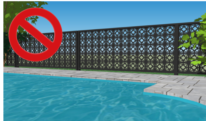
Exemple de clôture ornementale qui peut être escaladée facilement.
