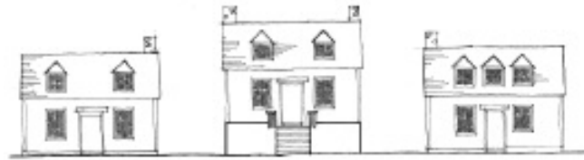
Fondation rehaussée exagérément
